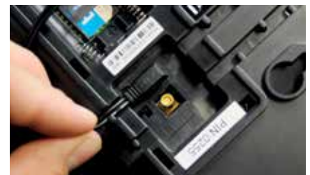
Netzanschluss und SIM-Karte sind hinter einer fest verschließbaren Abdeckung gut gegen Sabotage geschützt.
